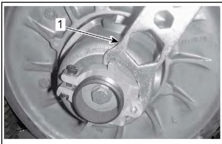
1. *Strumento di regolazione delle sospensioni*
