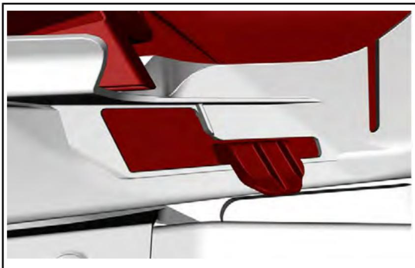
2. Abbassare l'estremità posteriore del modulo superiore della carrozzeria.
