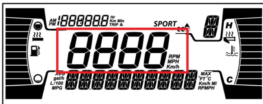
Visualizza il numero di giri del motore o la velocità del veicolo in Km/h o in MPH.
