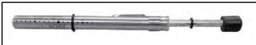
5. Impostare la flessione tra 40 mm a 50 mm mediante l'O-ring inferiore.
