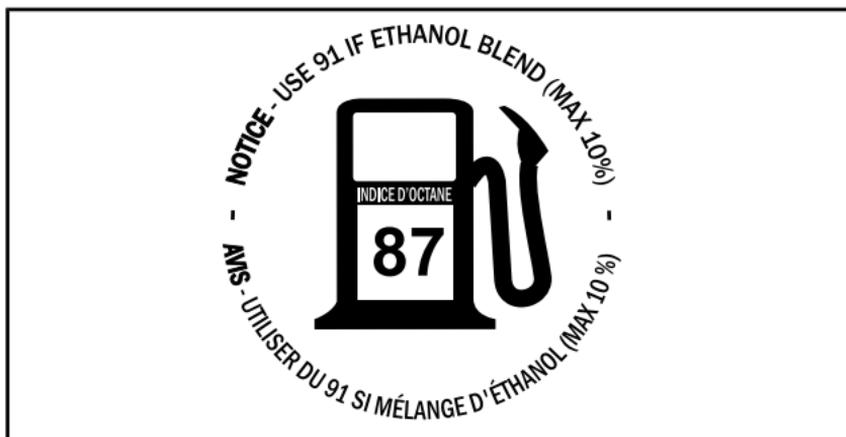
SITUÉ SUR LE BOUCHON DU RÉSERVOIR DE CARBURANT DES MOTEURS 600 EFI (DANS LES PAYS UTILISANT DES INDICES D'OCTANE AKI (RON+MON)/2 AFFICHÉS À LA POMPE)
