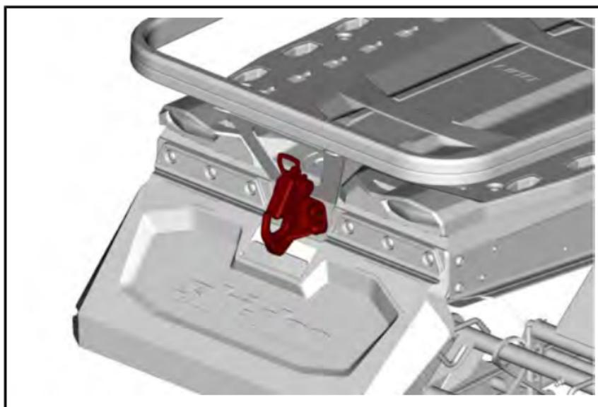
Pour ouvrir le crochet, poussez et tournez la poignée pour sortir la plaque de verrouillage.
