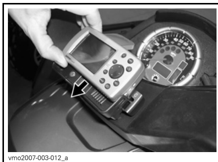
TYPBILD — INSTALLERA MOTTAGAREN
