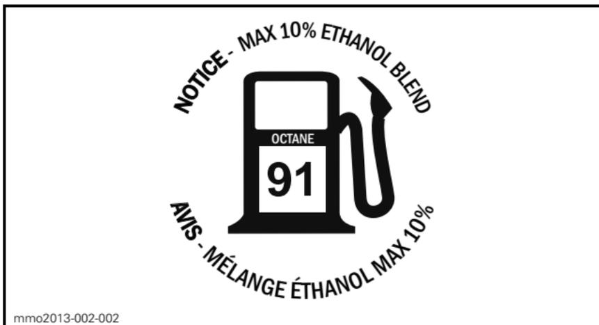
ON FUEL CAP - ON 600R E-TEC ENGINE (IN COUNTRIES USING PUMP POSTED AKI (RON+MON)/2 OCTANE RATINGS)
