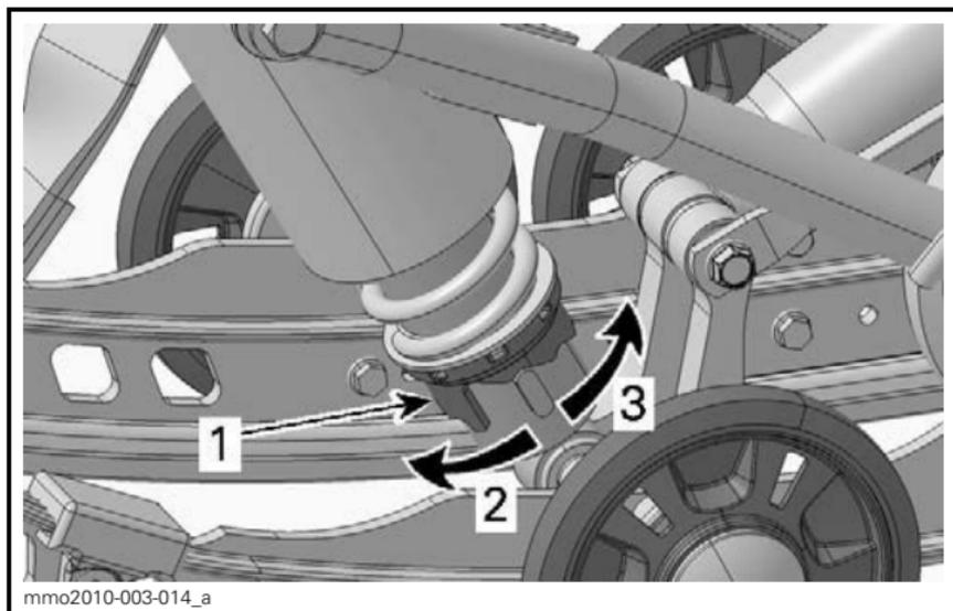
**CAM TYPE - MOTION CONTROL SHOCK ABSORBER**
