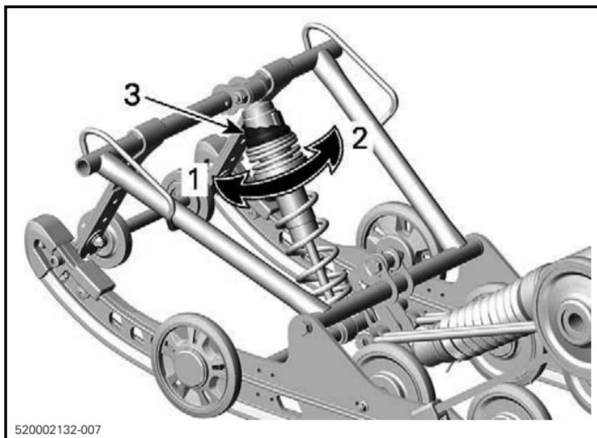
**CAM TYPE - HPG SHOCK ABSORBER**
