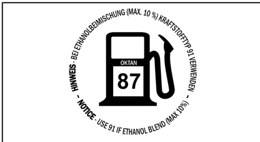
*AUF DEM KRAFTSTOFFTANKDECKEL – BEI 600 ACE UND 900 ACE MOTOREN (IN LÄNDERN, IN DENEN AUF DER ZAPFSÄULE AKI (RON+MON)/2-OKTANZAHLANGABEN VERWENDET WERDEN)*
