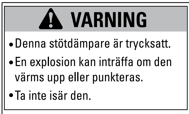
DEKAL 11 - PÅ GASFYLLDA STÖTDÄMPARE
