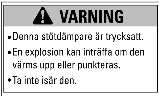
DEKAL 10 - PÅ GASFYLLDA STÖTDÄMPARE
