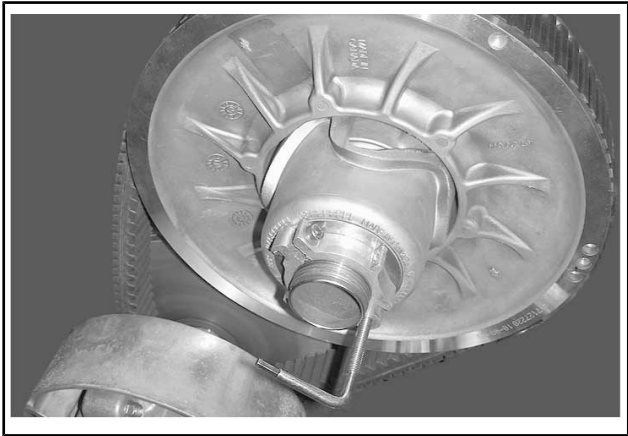
TYPEBILDE – FORLENGER FOR DRIVREIMSKIVE MONTERT PÅ JUSTERINGSNAV
