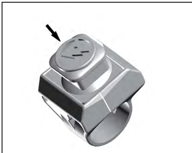
OFF (POIS PÄÄLTÄ) -ASENTO
