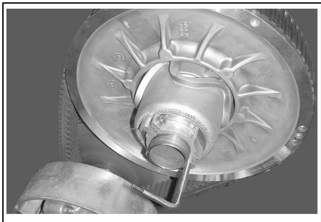
典型示例 - 安装在调节器轮毂上的皮带盘扩展器
