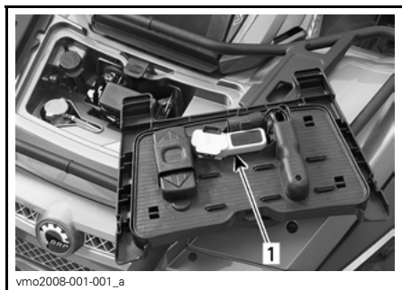
TÍPICO — PANEL DE ACCESO DELANTERO 1. Mando a distancia del cabestrante
