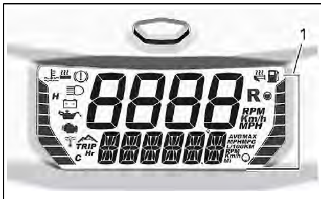
1. Søylemåler høyre side
