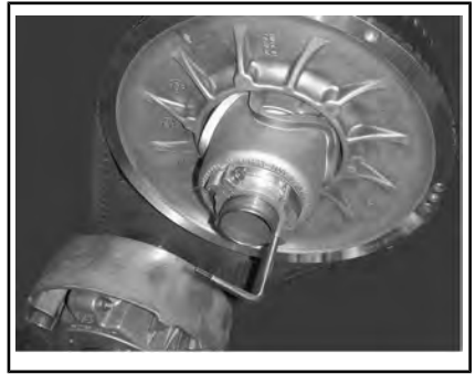
VARIATORNS UTVIDGARE INSTALLERAD PÅ JUSTERINGSNAVET
