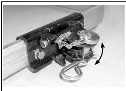
牵引配件时牵引挂接装置能自由移动
