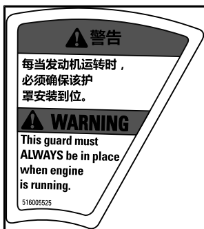
标签 15 - 位于制动盘护罩上（上漆通道）
