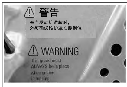
标签 15 - 位于制动盘护罩上（裸金属通道）
