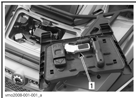
TYPISCH — VORDERE FAHRZEUGVERKLEIDUNG 1. Winden-Fernsteuerung
