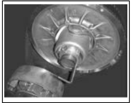
VARIATORNS UTVIDGARE INSTALLERAD PÅ JUSTERINGSNAVET
