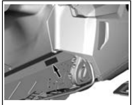
TYPISKT - NRMM IDENTIFIKATION PÅ TUNNELNS HÖGRA SIDA
