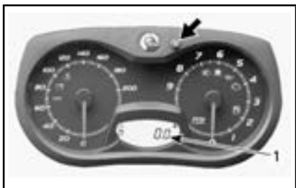
1. Режим счётчика моточасов (HrTRIP)
