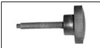
ÅPNINGSVERKTØYET FOR DREVET REIMSKIVE
