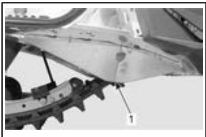
1. Tilgangshull for avtappingsplugg
