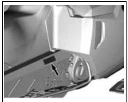
TYPISK – NRMM-IDENTIFIKASJON PÅ HØYRESIDEN AV TUNNELLEN
