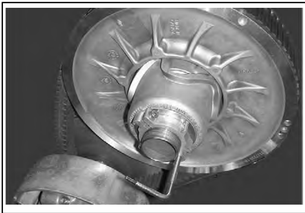
TYPBILD - VARIATORUTVIDGARE INSTALLERAD PÅ JUSTERINGSNAVET
