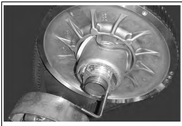
CONFIGURAZIONE TIPICA - DISPOSITIVO DI ESPANSIONE DELLA PULEGGIA INSTALLATO SUL MOZZO DEL REGISTRO.
