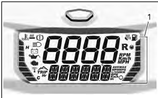
1. Søylemåler høyre side
