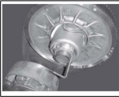
VARIATORNS UTVIDGARE INSTALLERAD PÅ JUSTERINGSNAVET
