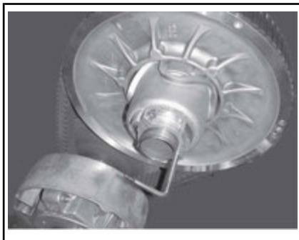
FORLENGER FOR DRIVREIMSKIVE MONTERT PÅ JUSTERINGSNAV
