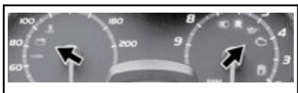
BILDET VISER – KONTROLLAMPER
