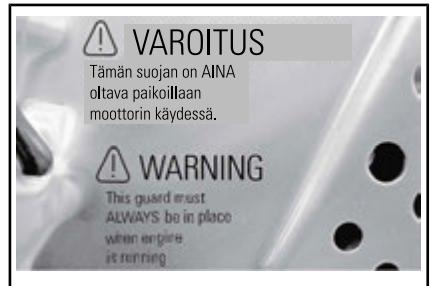
KILPI 16 – JARRULEVYN SUOJASSA (PELKKÄ METALLITUNNELI)
