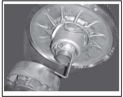
VARIATORNS UTVIDGARE INSTALLERAD PÅ JUSTERINGSNAVET
