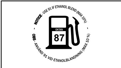
FINNS PÅ TANKLOCKET - PÅ 550F-, 600 ACE- OCH 900 ACE-MOTORER (I LÄNDER SOM ANVÄNDER AKI (RON+MON)/2 PUMPOKTANTAL)
