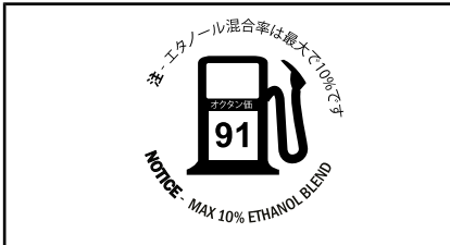
燃料キャップ上の表示 - 600 HO E-TECエンジン (ポンプに AKI (RON+MON)/2オクタン価が表示される国の場合)
