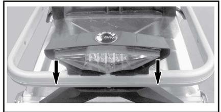
**AVVISO** Non estrarre eccessivamente l'alloggiamento del fanalino per evitare di danneggiare il cablaggio.
