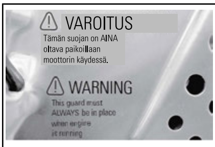
KILPI 12 – JARRULEVYN SUOJASSA (PELKKÄ METALLITUNNELI)
