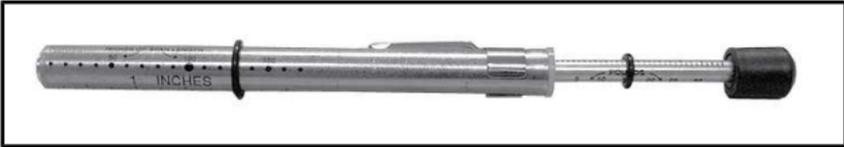
5. Impostare la flessione tra 30 mm and 35 mm mediante l'O-ring inferiore.
