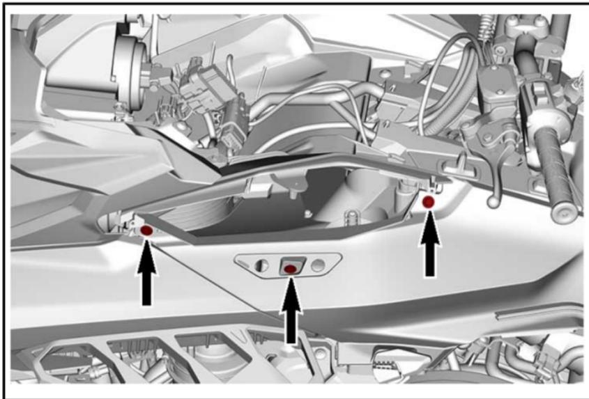
9. Libérez les crochets arrière du module de carrosserie supérieur des fentes dans la console.
