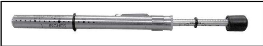
5. Réglez la flèche entre 30 mm and 35 mm au moyen du joint torique inférieur.
