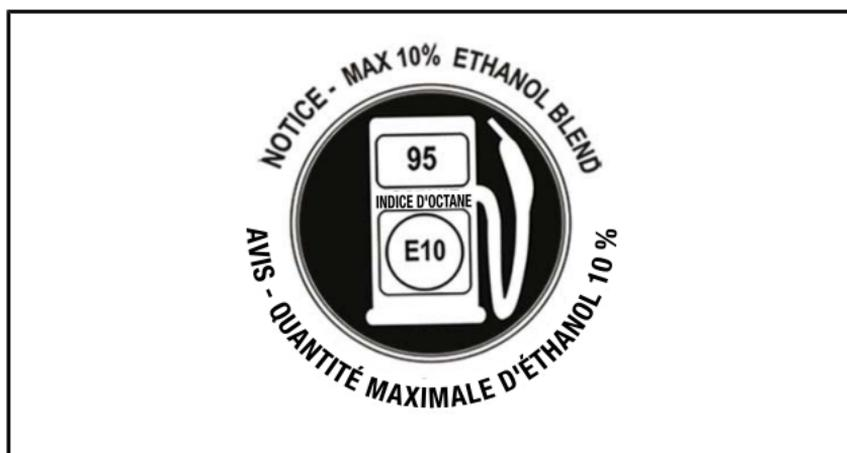
*SUR LE BOUCHON DU RÉSERVOIR DE CARBURANT - SUR LES MOTEURS TURBO (DANS LES PAYS UTILISANT DES INDICES D'OCTANE RON AFFICHÉS À LA POMPE)*
