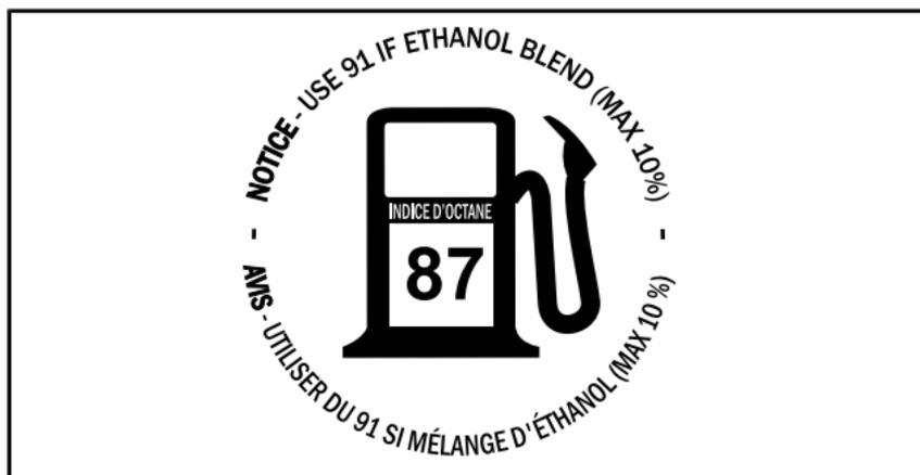
*SITUÉE SUR LE BOUCHON DU RÉSERVOIR DE CARBURANT
