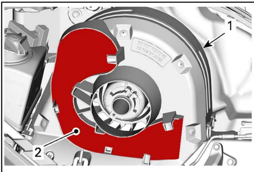
1. Protezione della cinghia di trasmissione
