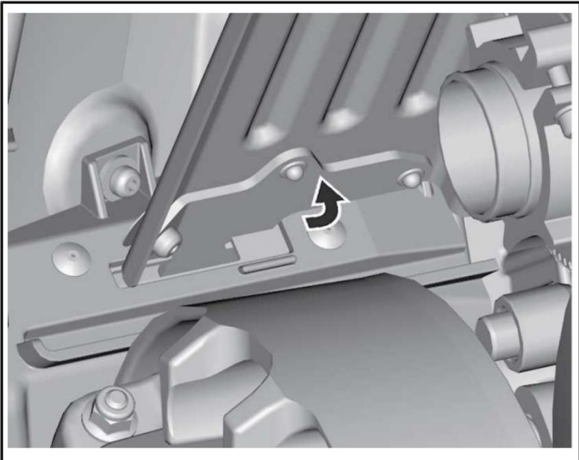
Posizionare la parte posteriore della protezione cinghia sopra il fermo e assicurarla mediante il perno di blocco.
