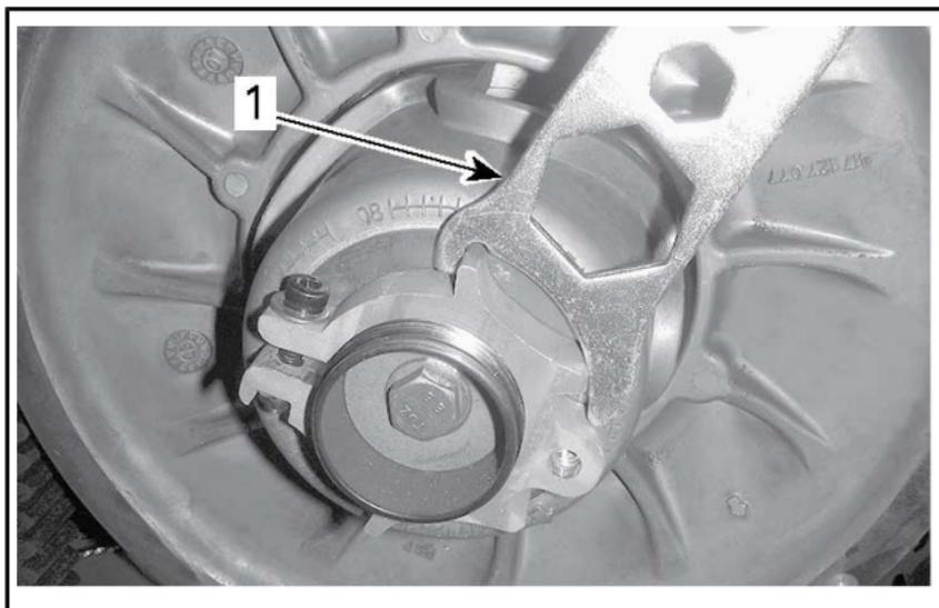
1. Strumento di regolazione delle sospensioni
