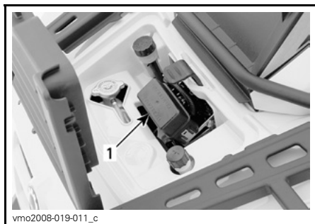
1. Caixa dos fusíveis da frente
