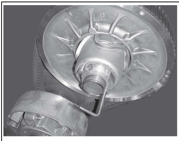
典型示例 - 安装在调节器轮毂上的皮带盘扩展器
