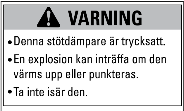
DEKAL 11 - PÅ GASFYLLDA STÖTDÄMPARE
