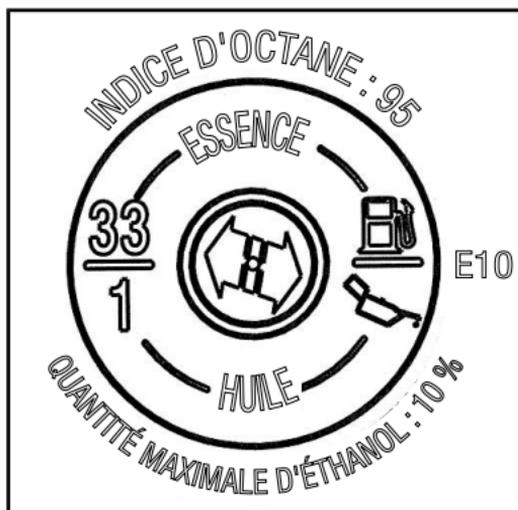
*SUR LE BOUCHON DU RÉSERVOIR DE CARBURANT - DANS LES PAYS UTILISANT DES INDICES D'OCTANE RON AFFICHÉS À LA POMPE*
