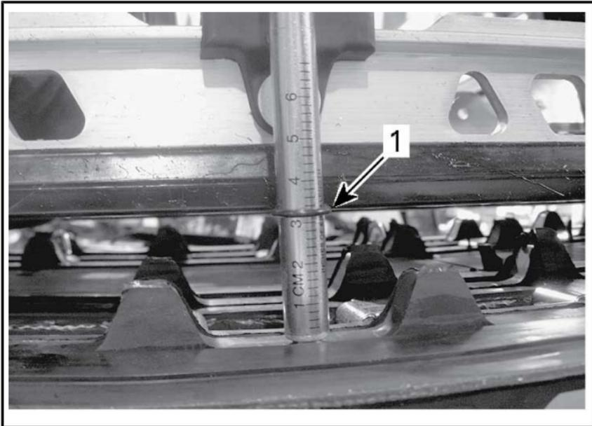
1. Joint torique de déflexion aligné avec la glissière
