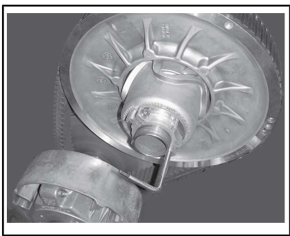
VARIATORNS UTVIDGARE PÅ JUSTERINGSNAV
