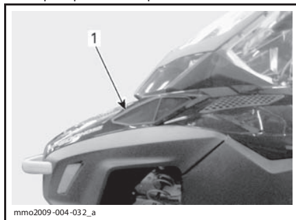
1. Фильтр предварительной очистки
