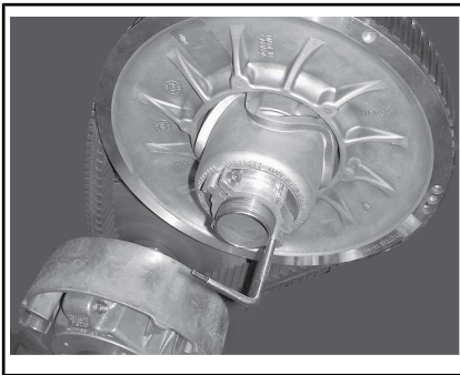
DISPOSITIVO DI ESPANSIONE DELLA PULEGGIA SUL MOZZO DEL REGISTRO
