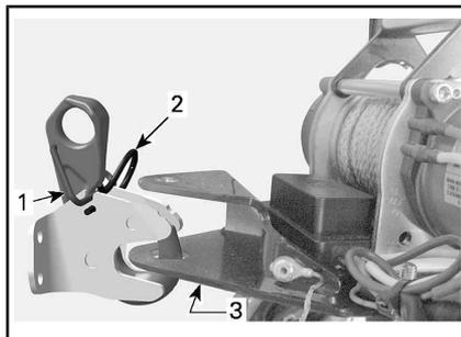
1. Mécanisme de verrouillage
