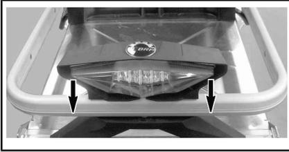
**AVIS** Les broches de retenue en plastique pourraient se casser si le bloc optique de feu arrière est tiré latéralement. Évitez tout mouvement latéral lorsque vous extrayez le bloc optique de feu arrière.
