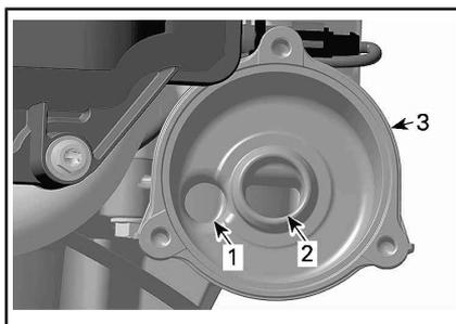
1. Orifice d'entrée de l'huile sous pression refoulée par la pompe à huile
