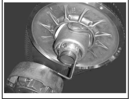
*TENDEUR DE COURROIE SUR MOYEU DE RÉGLAGE*
