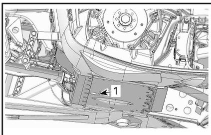
1. Ouverture du châssis pour atteindre le bouchon de vidange
