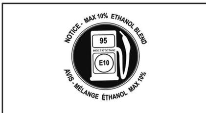
*SITUÉE SUR LE BOUCHON DU RÉSERVOIR DE CARBURANT - SUR LE MOTEUR E-TEC (DANS LES PAYS UTILISANT DES INDICES D'OCTANE RON AFFICHÉS À LA POMPE)*
