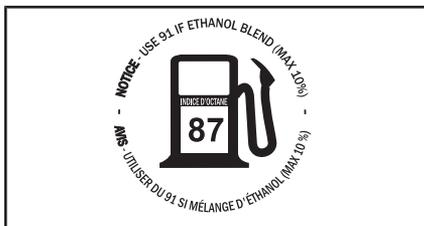
*SITUÉE SUR LE BOUCHON DU RÉSERVOIR DE CARBURANT - SUR LES MOTEURS DES MODÈLES 1200 4-TECH ET 900 ACE (DANS LES PAYS UTILISANT DES INDICES D'OCTANE AKI (RON+MON)/2 AFFICHÉS À LA POMPE)*
