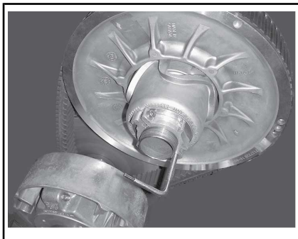
VARIAATTORIN AVAUSTYÖKALU SÄÄTIMEN NAVASSA
