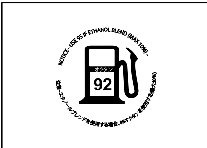
燃料キャップ上 - 550Fと600 ACEエンジン (RONオクタン値を使用する国において)
