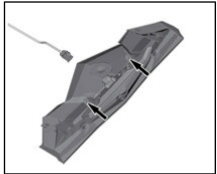
テールランプをテールランプサポートに固定する固定ボルト
