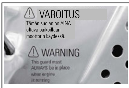
KILPI 16 – JARRULEVYN SUOJASSA (PELKKÄ METALLITUNNELI)
