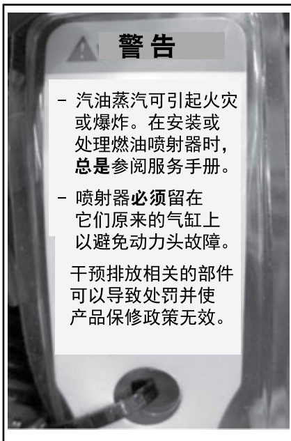
标签 18 - 位于喷油器上 - E-TEC 型号
