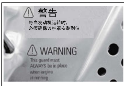
标签 16 - 位于制动盘护罩上 (裸金属通道)
