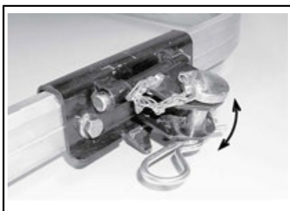
牵引配件时牵引挂接装置能自由移动
