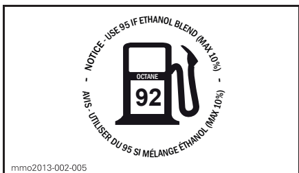
НА КРЫШКЕ ТОПЛИВНОГО БАКА - МОДЕЛИ 550 F, 600 ACE И 900 ACE (В СТРАНАХ, ИСПОЛЬЗУЮЩИХ ОЧИ (RON) ДЛЯ ОБОЗНАЧЕНИЯ ОКТАНОВОГО ЧИСЛА)
