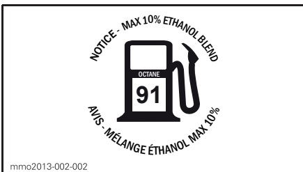
НА КРЫШКЕ ТОПЛИВНОГО БАКА - МОДЕЛИ 600 NO E-TEC (В СТРАНАХ, ИСПОЛЬЗУЮЩИХ АКІ ДЛЯ ОБОЗНАЧЕНИЯ ОКТАНОВОГО ЧИСЛА)
