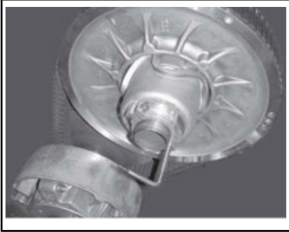
VARIAATTORIN AVAUSTYÖKALU ASENNETTUNA SÄÄTIMEN NAPAAN
