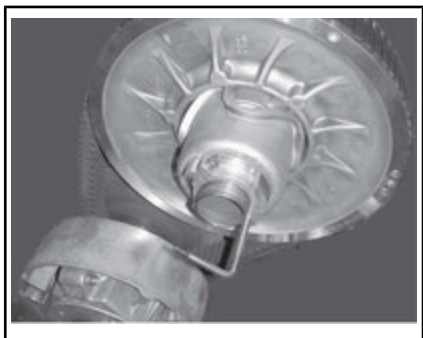
VARIATORNS UTVIDGARE INSTALLERAD PÅ JUSTERINGSNAVET
