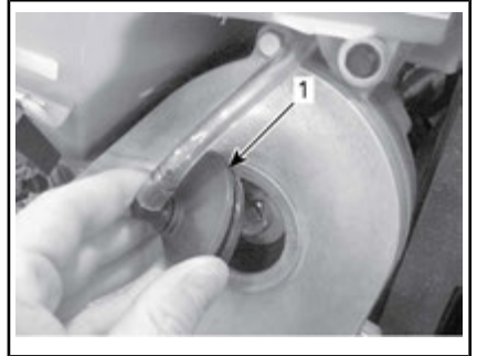
1. Bouchon de remplissage
