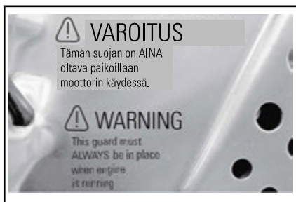
KILPI 14 - JARRULEVYN SUOJASSA (PELKKÄ METALLITUNNELI)
