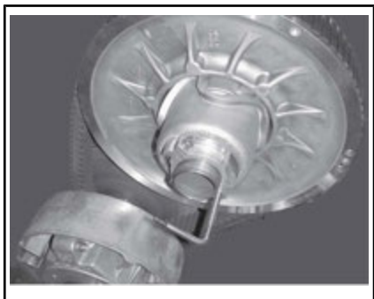
SCHEIBEN-EXPANDER AN NABE DER EINSTELLVORRICHTUNG MONTIERT
