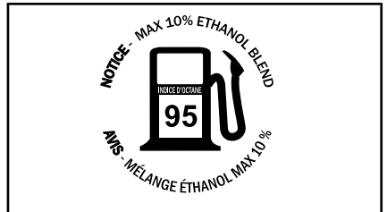
SITUÉE SUR LE BOUCHON DU RÉSERVOIR DE CARBURANT - SUR LE MOTEUR E-TEC (DANS LES PAYS UTILISANT DES INDICES D'OCTANE AKI (RON+MON)/2 AFFICHÉS À LA POMPE)
